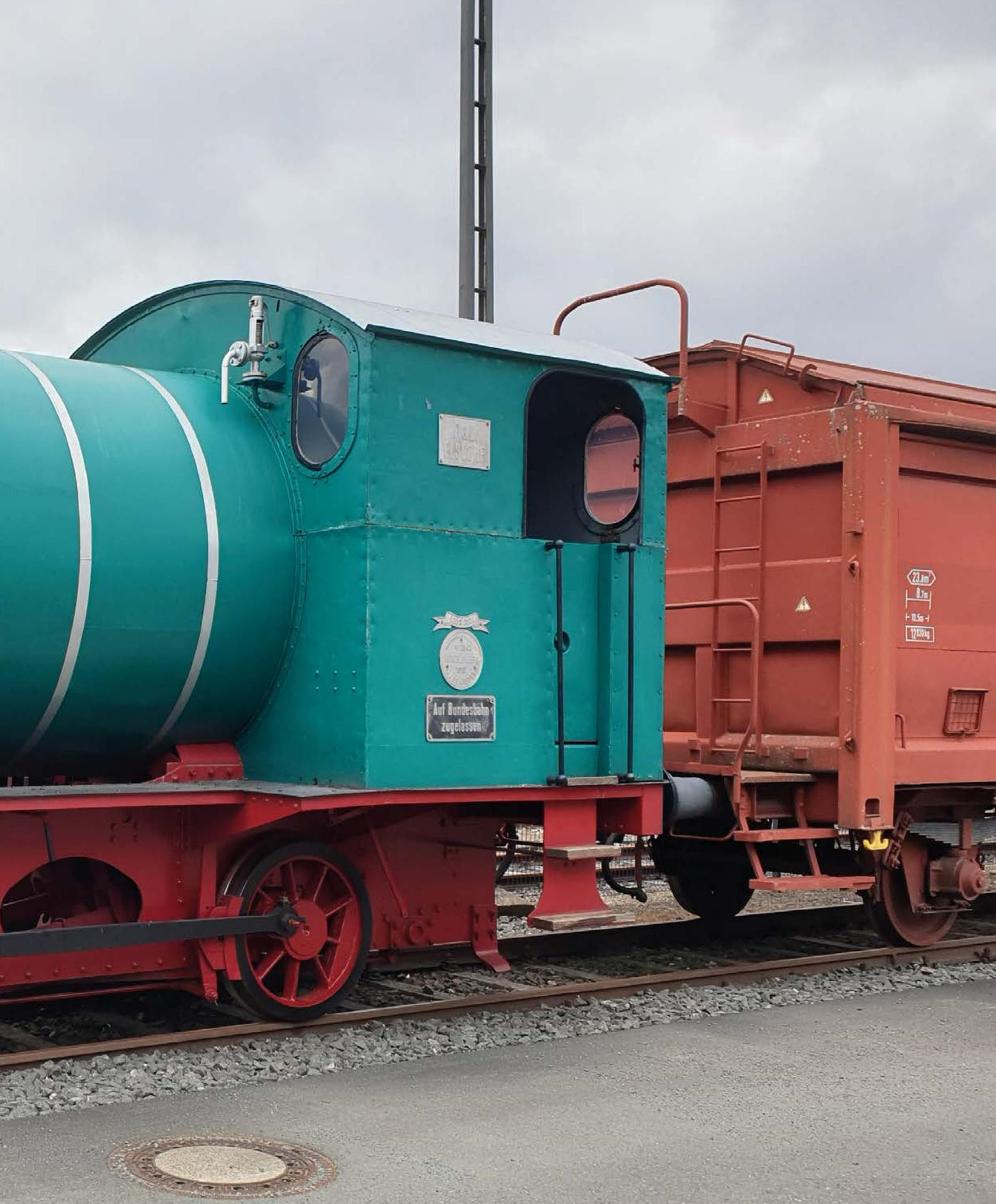
Dampfspeicherlok Fabrik-Nr. 2542 vor einem Fotogüterzug im Freigelände des DDM
