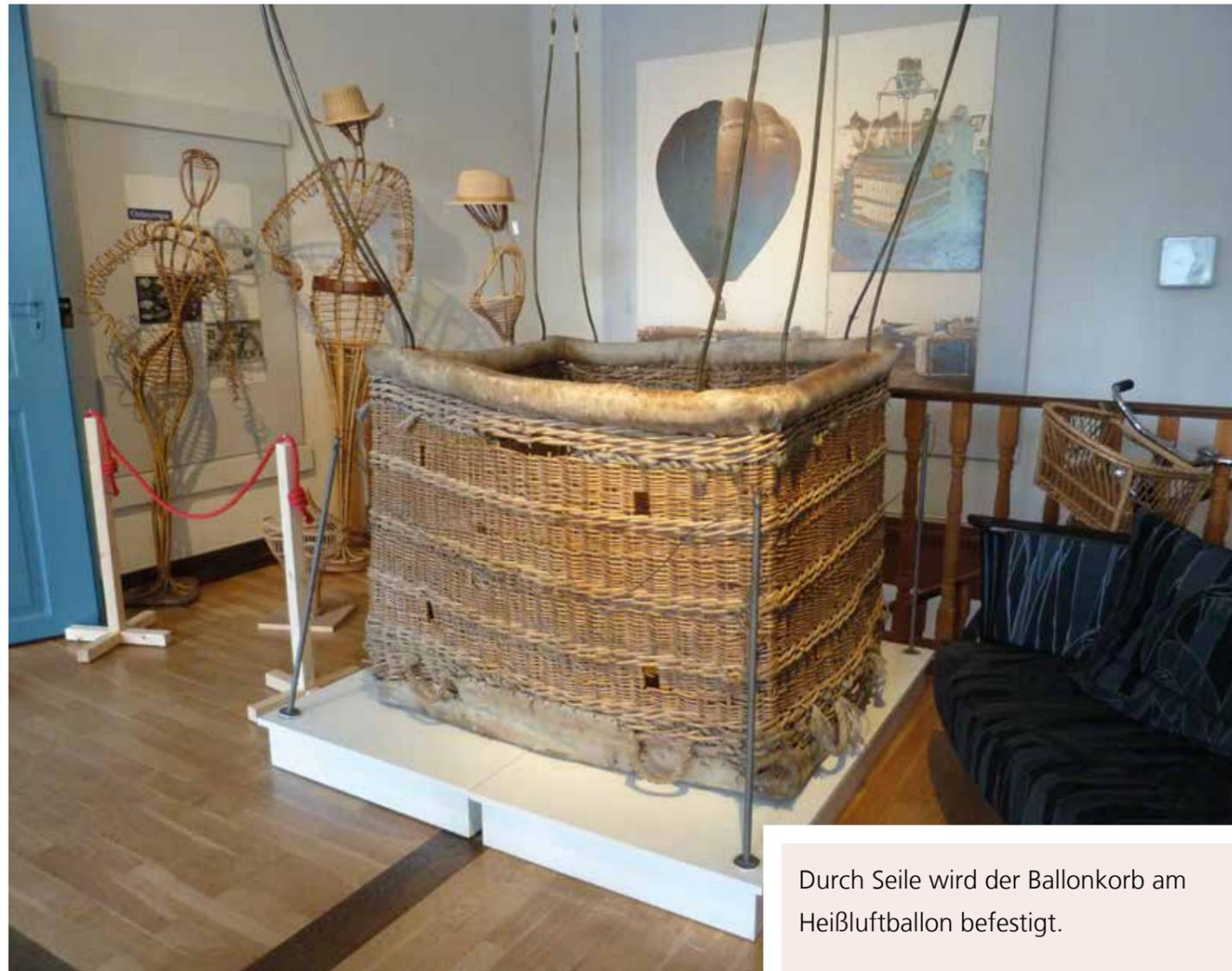
Durch Seile wird der Ballonkorb am Heißluftballon befestigt.
